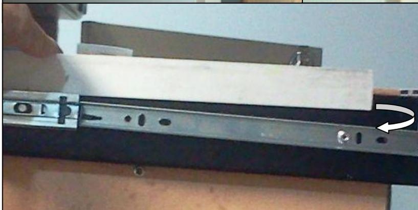
Com o peso de poucas pastas, os trilhos apresentaram torção longitudinal, além de excessivo desnível da haste telescópica entre a base e a sua extremidade. Essa chegou a escapar do conjunto devido à torção, caindo ao chão. Não há, portanto, reforço nas corredeiras. Tal configuração põe em risco a integridade de magistrados e servidores.
