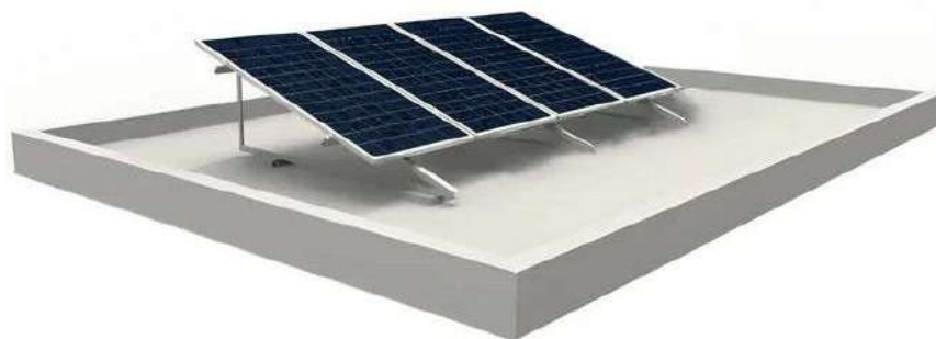
Figura 3 – Representação montagem da usina na laje.
