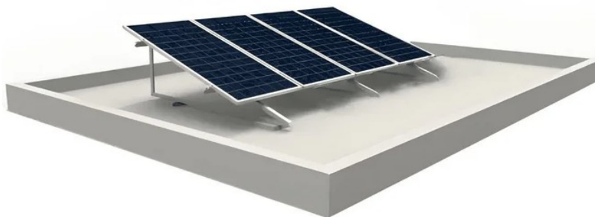
Figura 5: Representação da montagem do suporte na laje.
