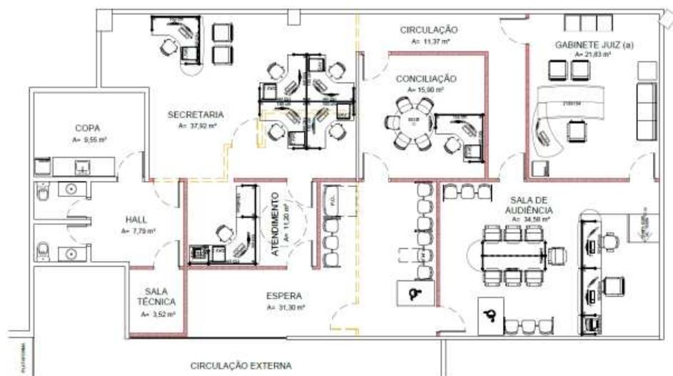
*Figura 1. Planta de demolição e construção da concorrência 01/2024. Os fechamentos destacados em vermelho identificam a construção de drywall com preenchimento em lã de*
