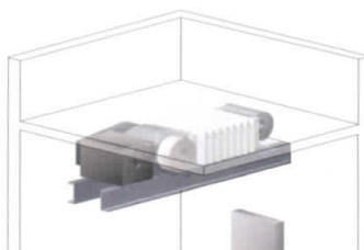
Possibilidade de instalação da SGB 142 na caixa de corrida.
